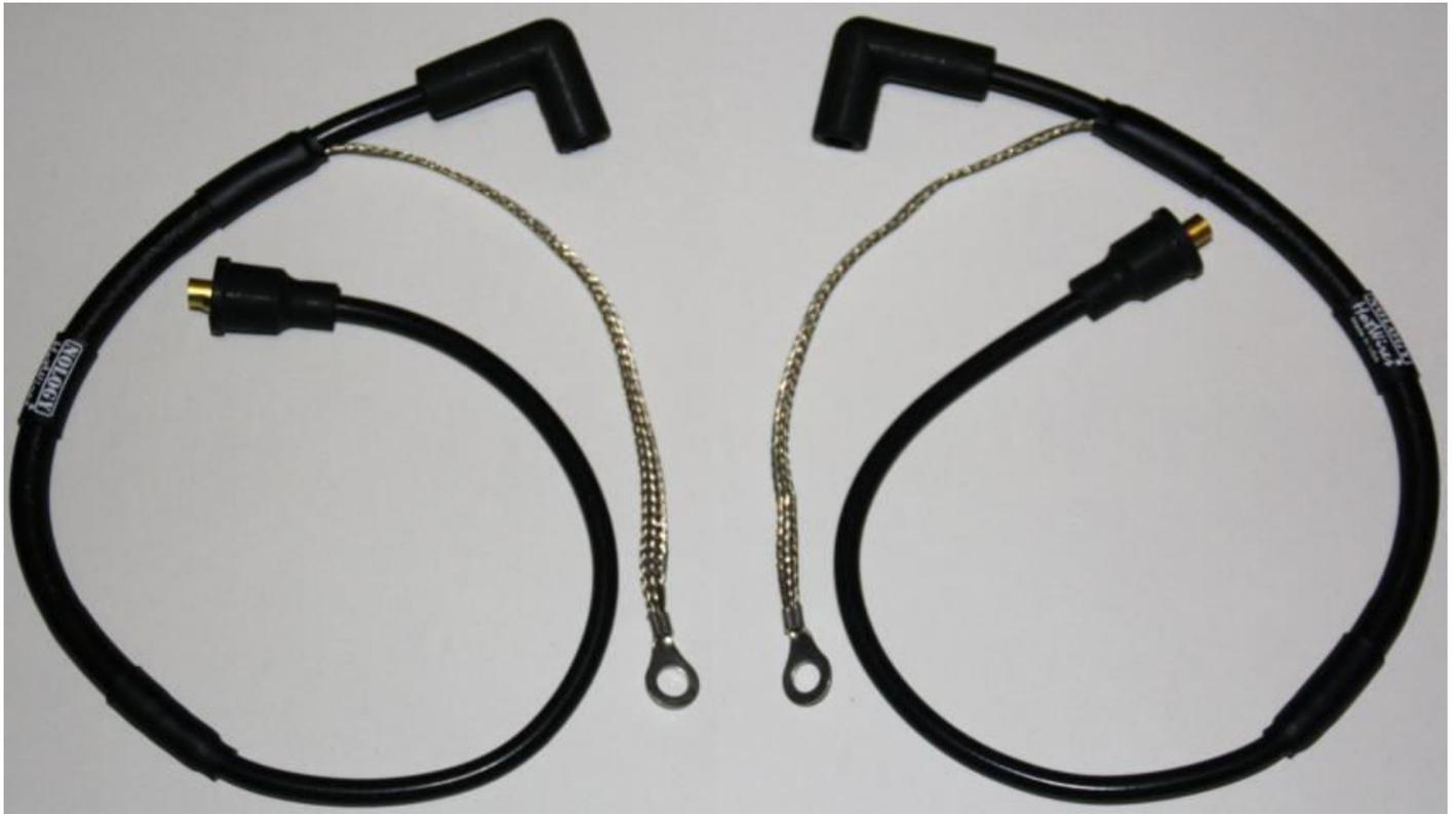
Das Zündkabel als Sekundärzündsystem ist ein Blindwiderstandskabel und funktioniert auf Grund des Schichtaufbaus als Kondensator
