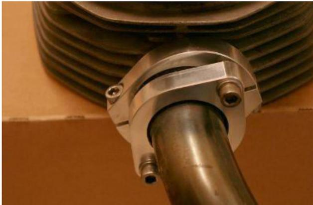
Sternmutternschlüssel? Nicht mehr notwendig! Defekte Gewinde aufschweißen? Nicht notwendig, da selbst ein noch verbliebener Gewindegang zur sicheren Befestigung ausreicht!
