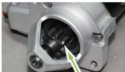
**Auf Wunsch ist auch ein NEUER Original Valeo-Anlasser mit 8 Zähnen lieferbar.** Das Feldgehäuse besitzt eine Zusätzliche Sicherung der Magnete gegen sich lösen vom Statorgehäuse.
