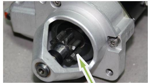
**Auf Wunsch ist auch ein NEUER Original Valeo-Anlasser mit 8 Zähnen lieferbar.** Das Feldgehäuse besitzt eine Zusätzliche Sicherung der Magnete gegen sich lösen vom Statorgehäuse.
