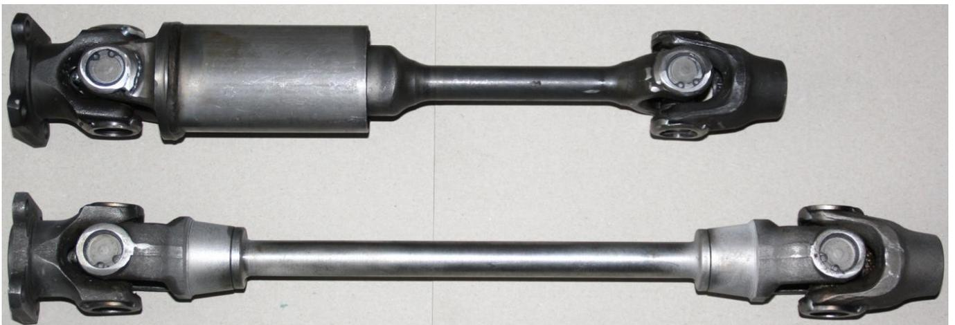
Hier im Vergleich eine Abschmierbare Serien-Welle der R100 GS und darunter eine um 70mm längere starre Antriebswelle für die Schwinge der 4-Ventiler-Modelle. zB. für Umbauten der 4-Ventiler-Schwinge in ein 2-Ventiler-Fahrwerk... wie zB. R80/100GS...
