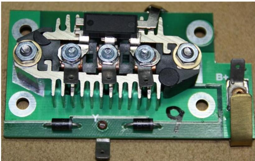
Diodenplatte einzeln (mit Haltesatz und Anschlusskabeln) 145,00eur
