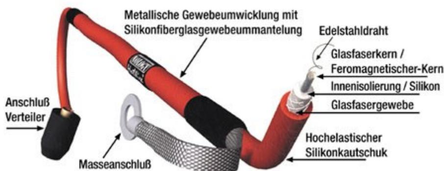
Die Länge der Zündkabel ist großzügig, so das es beim Verlegen wohl keinen Ärger geben sollte. Der Einbau des Kabels gestaltet sich denkbar einfach: das Original Zündkabel entfernen und durch das Nology "Hot-Wire" Zündkabel ersetzen. Danach den zusätzlichen Masseanschluss an Ventildeckel oder am Rahmen oder Motor anschrauben.
