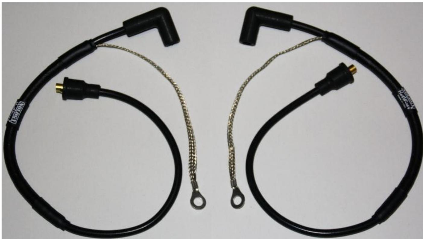
Das Zündkabel als Sekundärladesystem ist ein Blindwiderstandskabel und funktioniert auf Grund des Schichtaufbaus als Kondensator
