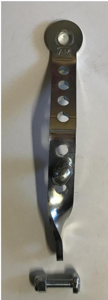
Montagesatz incl. Drehbarem Widerlager des Bremsbowdenzuges.
