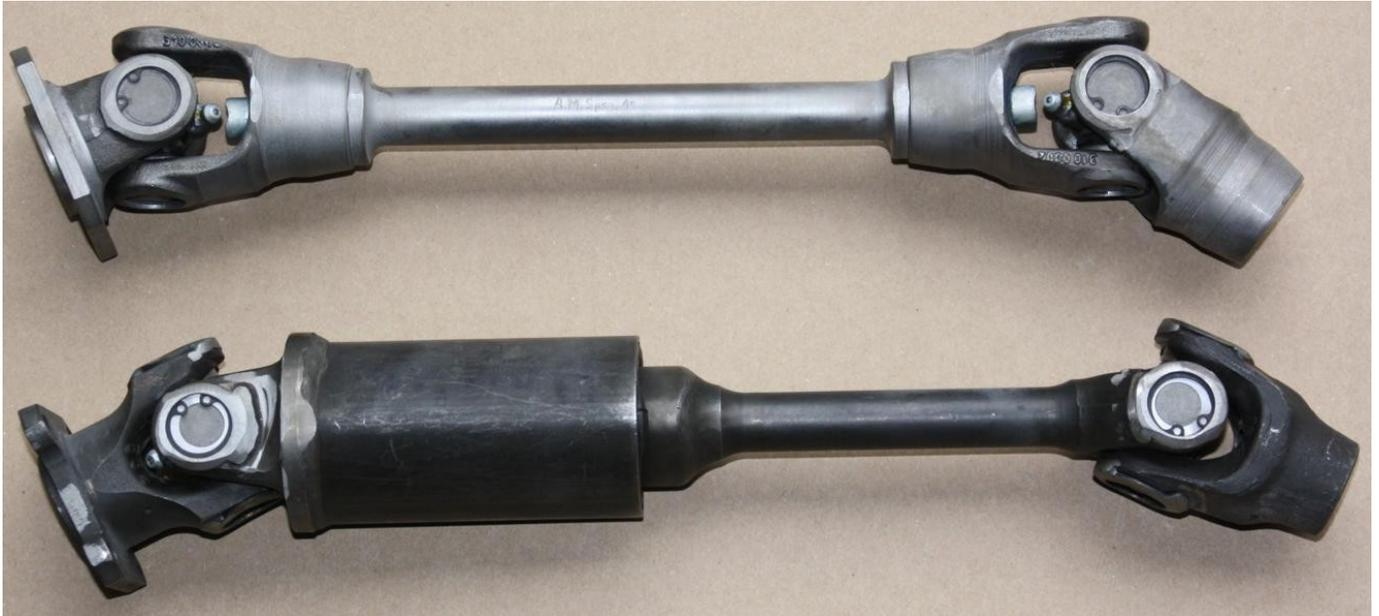
im Vergleich eine Abschmierbare Serien-Welle der R80/100 R,GS.. und darüber eine Gleichlange komplett neu konstruierte starre Antriebswelle.
